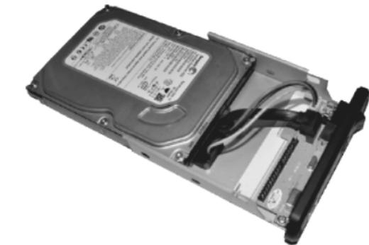
4. Coloque los 4 tornillos para fijar el disco duro en la bandeja.
