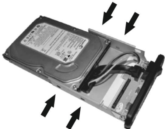
5. Cierre la carcasa totalmente y coloque los tornillos para fijar la tapa de la carcasa
